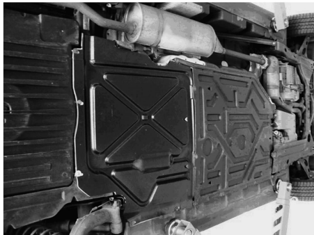
图 1 用于汽车底部装置的 PP 自增强材料
